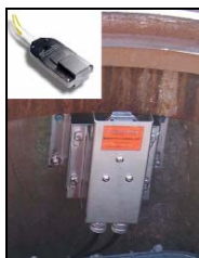
Manhole Lid Sensors
